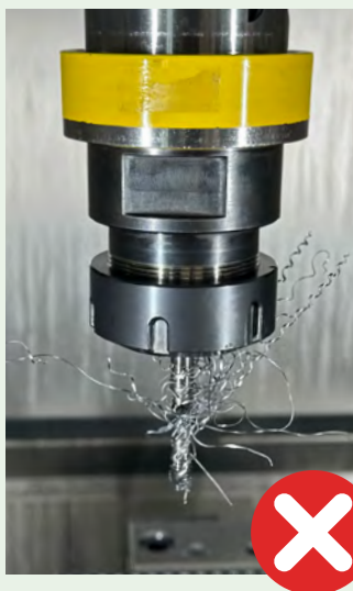
Concorrente A utensile dopo 6 filetti
