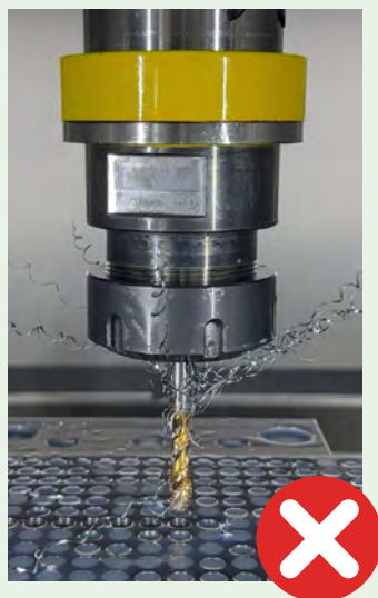
Concorrente B utensile dopo 14 filetti
