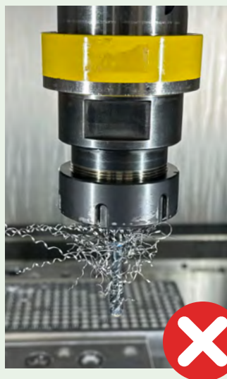
Concorrente C utensile dopo 16 filetti
